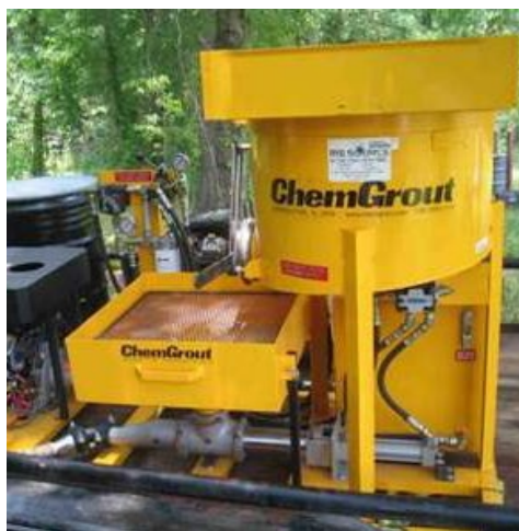
Figura 7. Il miscelatore per malte con serbatoio di alimentazione e pompa di iniezione.
